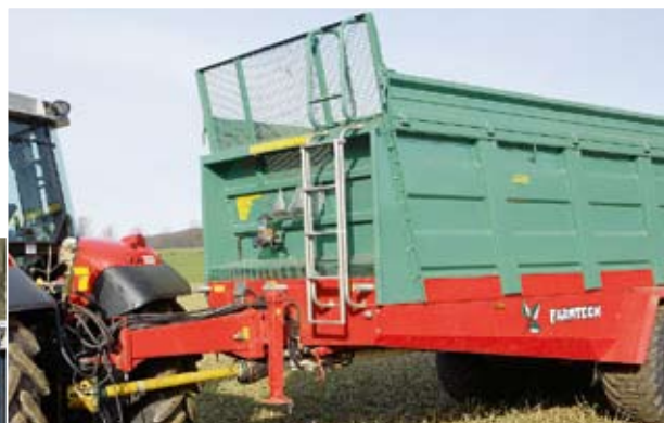
Stabile Abstellstütze, bequeme Aufstiegsleiter, einfache Spanner für den Kratzboden – nur die seitlichen Verkleidungsbleche unter der Ladefläche halten wir für überflüssig.
