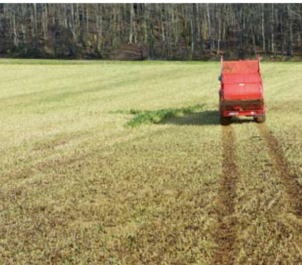
Das Breitstreuwerk hat 1,35 m Durchgang und arbeitet mit zwei massiven Reißwalzen sowie zwei Tellern mit je 96 cm Durchmesser und vier Schaufeln. Die Quer- und Längsverteilung wurde von der DLG in einem Fokus-Test mit gut bis sehr gut bewertet.
