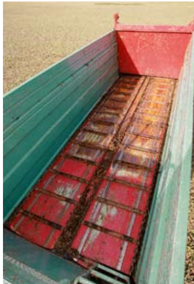
Der Laderaum fasst 15 m 3 , die oberen 30 cm vom Aufbau lassen sich aber leicht abklappen, um die Überladehöhe auf 2,50 m zu verringern. Die vier Kratzbodenketten laufen auf Schienen über den Stahlboden.
